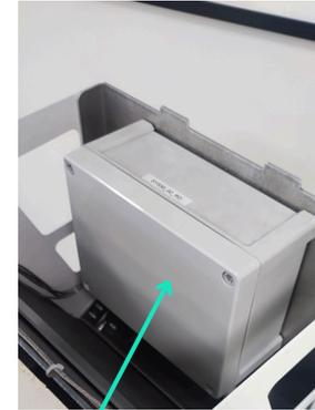
Diese wasserdichte Einheit wird mit vier BTR-Schrauben am Zielrahmen montiert. Jegliche Manipulation der elektronischen Einheit führt zum Verlust der Hardwaregarantie. Für alle Wartungsarbeiten muss es direkt an SPORT QUANTUM zurückgesendet werden.
