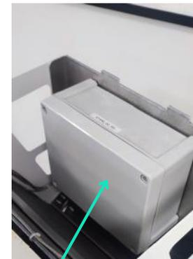
Ce module étanche est fixé au châssis de la cible par 4 vis BTR.
