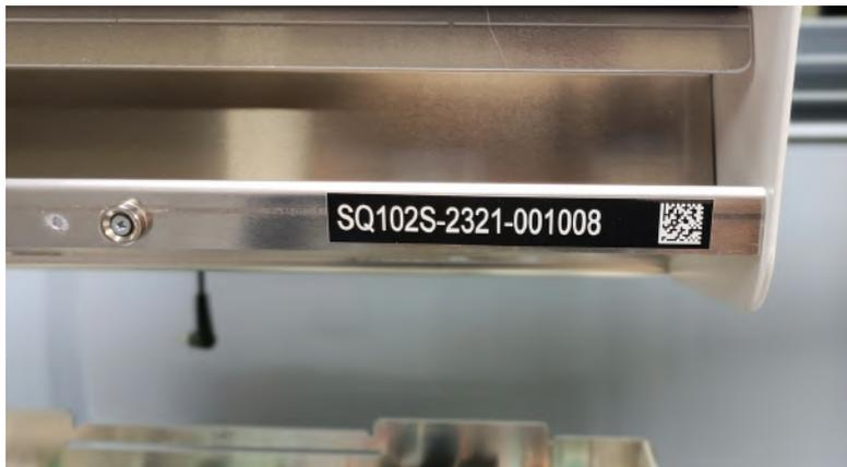
Le numéro de série se trouve sur le châssis en bas à droite à l'avant de la cible.
